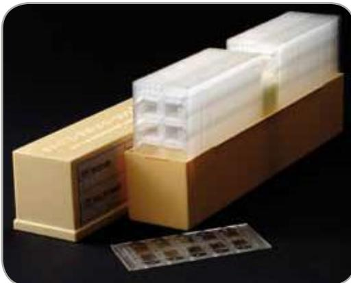
Il Fast Read 102® è il vetrino monouso che permette, in maniera rapida ed efficace, la lettura di 10 conte cellulari contemporaneamente. Basta trasferire con l'apposita pipetta pasteur BSV140 una goccia di soluzione da analizzare nella camera e, per capillarità, si riempirà la celletta corrispondente consentendo quindi una rapida lettura al microscopio.
