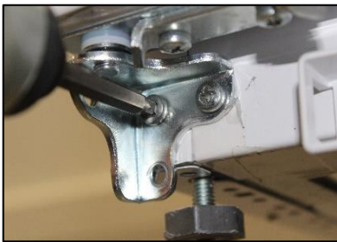
Fig 22. Puerta de reacondicionamiento en bisagra LH
