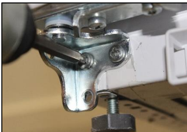
Abb. 22. Nachrüßtür am LH-Scharnier
