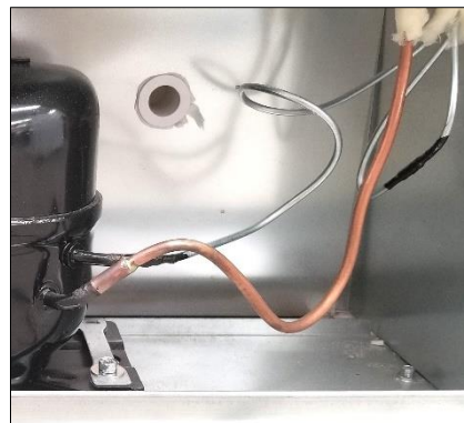
Figura 6a. Vista externa del puerto de acceso
