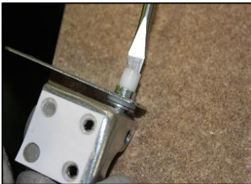
Fig 15. Gire y ajuste la bisagra
