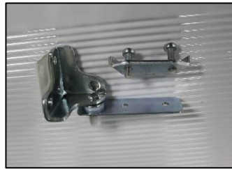
Fig 13. Retire el soporte y la bisagra
