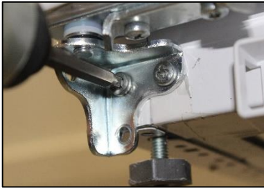
Figura 22. Porta Refit su cerniera LH
