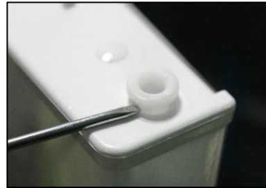
Abb. 21. Scharnierbuchse entfernen und nachrüsten
