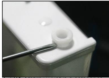
Fig 21. Retire y vuelva a colocar el casquillo de la bisagra
