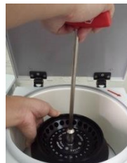
Werkzeug für Rotor mit Mutter
