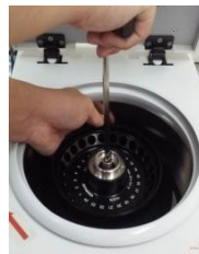
Werkzeug für Rotor ohne Mutter
